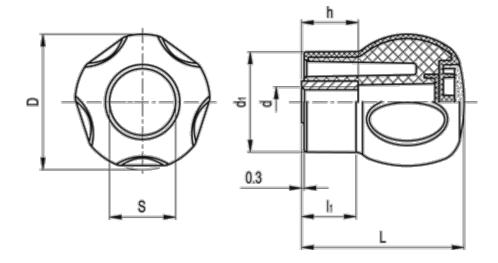
D = 50 d1 = 37 d 6H = M10 h = 20 L = 60 l1 = 20 Weight (g) = 82
